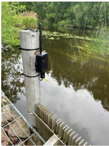
Figur 1. TV: Mörrumsåns Vattenråd ansvarar för etablering av ett samordnat nivåmätningssystem i hela avrinningsområdet. Under 2025 sattes 11 stationer upp och projektet fortsätter 2026. Enskilda anläggningar (stationer) kommer ges möjlighet att ansluta sig till systemet för samordnad vattenhushållning i avrinningsområdet. TH: Rester av gammalt pappersbruk i Skyeån åtgärdades så det blev passerbart för alla förekommande fiskarter samtidigt som dess kulturvärden bevaras.
